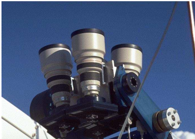
Obrázek 14: Optický systém ROTSE-1 (Internetová stránka projektu ROTSE, 2002)
